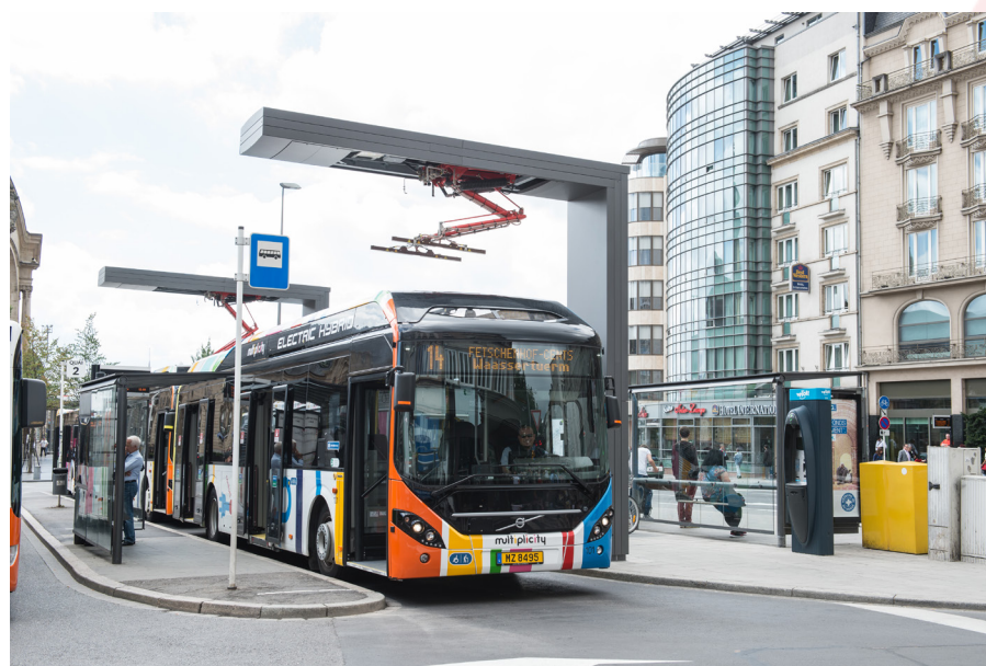
Nabíjanie pantografom ABB v štandarde OPPCharge
